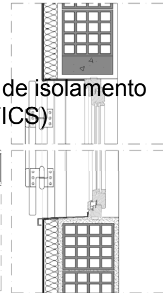
PORMENOR E Ligação do sistema com um vão substituindo o peitoril original
