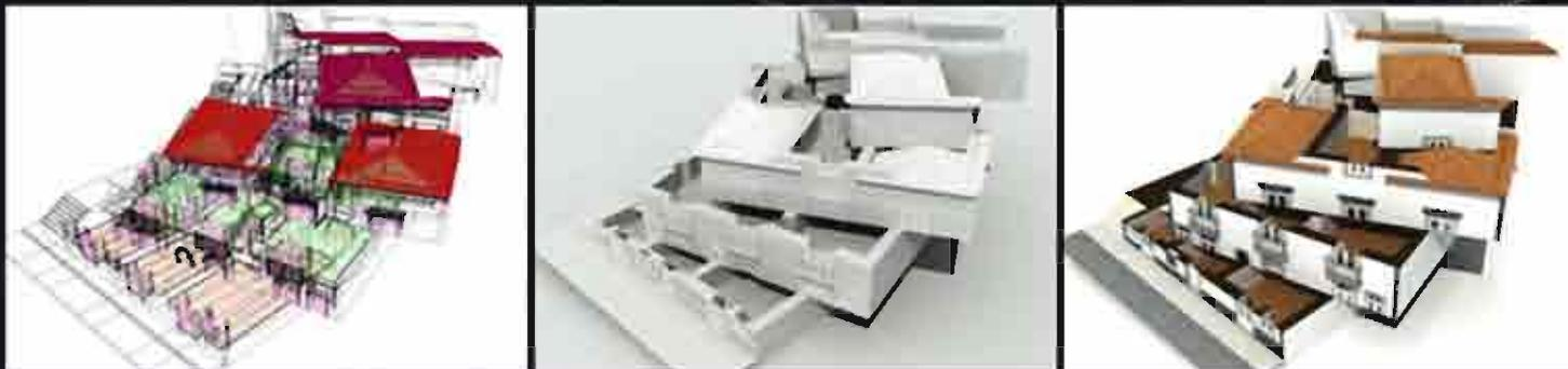
Concebida para um campo vasto de aplicações – entre elas a **arquitectura, engenharia, arqueologia e multimédia** – a **fotogrametria** permite o levantamento rápido e fiável de edifícios, monumentos e outras construções, podendo servir de base para o levantamento de tipologias, materiais e anomalias dessas construções.
