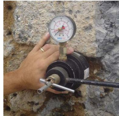
Figura 31: Exemplo do dispositivo de arrancamento com o registo da respectiva força máxima.
