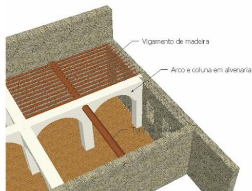
Figura 6: Exemplo de esquema estrutural de pavimento em madeira apoiado sobre arcos e colunas de alvenaria resistente em basalto (piso térreo).
