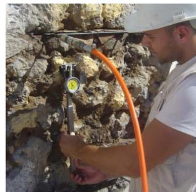
Figura 35: Leitura das deformações com o alongômetro de milésimos.
