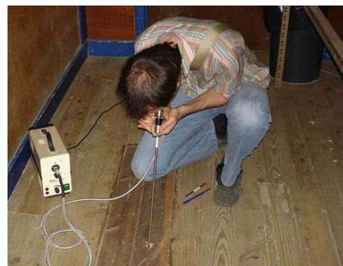
Figura 20: Observação boroscópica em pavimento.
