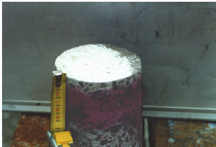
Fig. 1 - Reacção da fenolftaleína numa carote de betão recém-extraída. O teste indica que o betão está carbonatado até a uma profundidade da ordem dos 1,5 a 2 cm.
