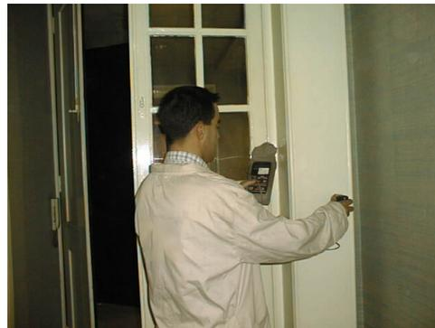
Fig. 2 – Detecção com o pacómetro de elementos estruturais ocultos.
