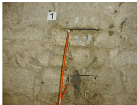
Fig. 4 – Introdução de pressões na amostra ensaiada de uma parede de alvenaria.
