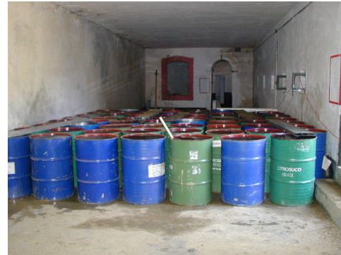
Fig. 2 - Sistema de carga constituído por bidões de água durante fase da carga.
