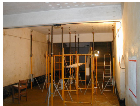
Fig. 3 - Deflectómetros numa laje ensaiada.
