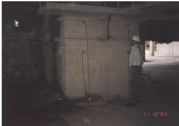
Fig. 2 - Disposição dos acelerómetros durante o registo das vibrações dum maciço.
