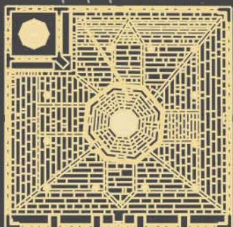
Levantamento fotogramétrico de pavimento - Convento de Jesus, em Setúbal.
