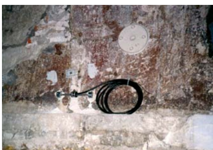
13 | Três dispositivos para monitorização expedita. De cima para baixo: base iclinométrica; fissurómetro tipo Tell Tale; fissurómetro de corda vibrante.
