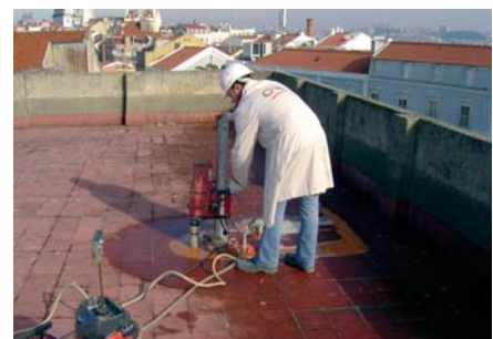
Extracção de carote na laje de cobertura de um edifício, para caracterização do material. 19
