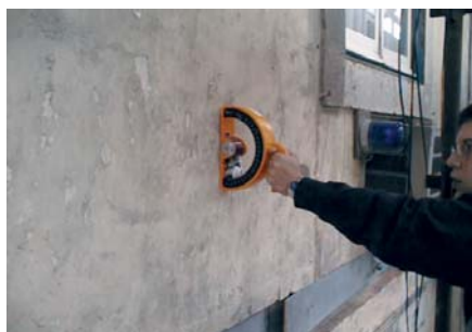
4 | Caracterização mecânica com esclerómetro de pêndulo.
