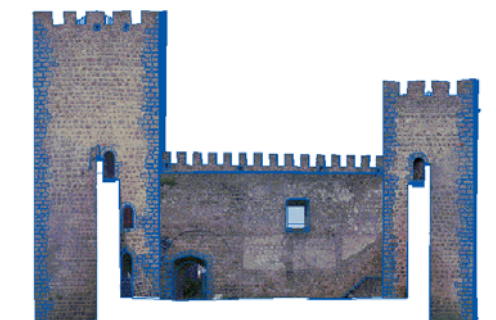
2 | Levantamento fotogramétrico do Castelo de Belver, Portalegre: atribuição de pontos para criação de modelo tridimensional e posterior desenho com base em ortofotografia
