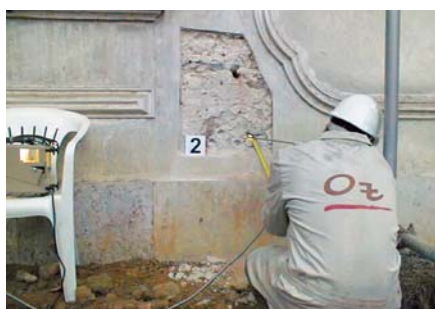
6 | Observação boroscópica de uma parede.
