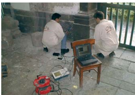
11 | Ensaio de impulso mecânico.
